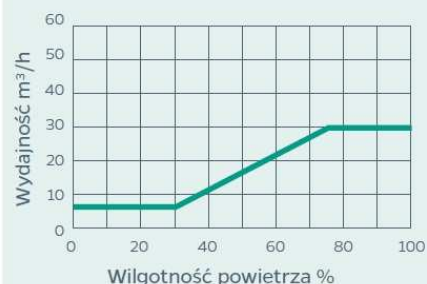
Wykres zależności przepływu powietrza od wilgotności @10 Pa.
